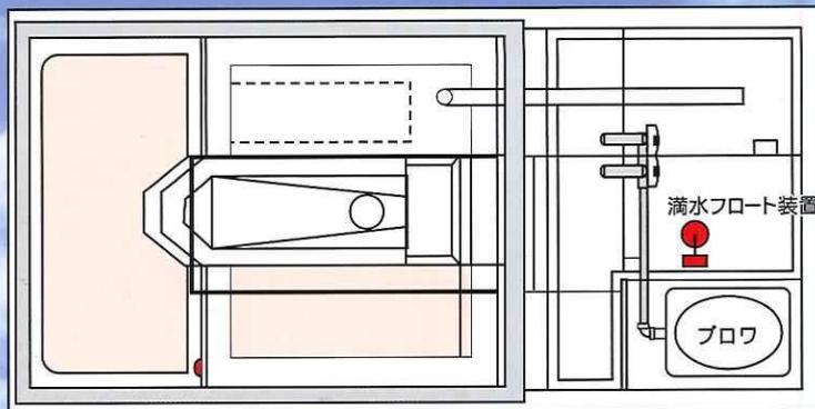
陸上自衛隊の野外訓練用トイレとして、防衛庁(現防衛省)と共同開発し完成させた、下水設備の必要がない移動式の自己処理型水洗トイレです。
